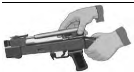
Рис. 7.16. Отделить затворную раму с затвором
