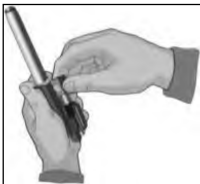
Рис. 7.16. Отделить затворную раму с затвором
