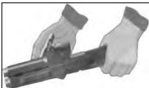
Рис. 7.17. Отделить затвор от затворной рамы
