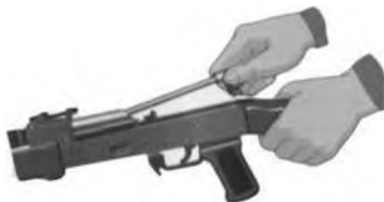
Рис. 7.13. Отделить Рис. 7.14. Отделить крышку шомпол ствольной коробки
