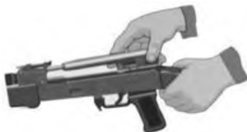
Рис. 7.16. Отделить затворную раму с затвором
