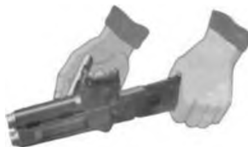
Рис. 7.18. Отделить газовую трубку со ствольной накладкой
