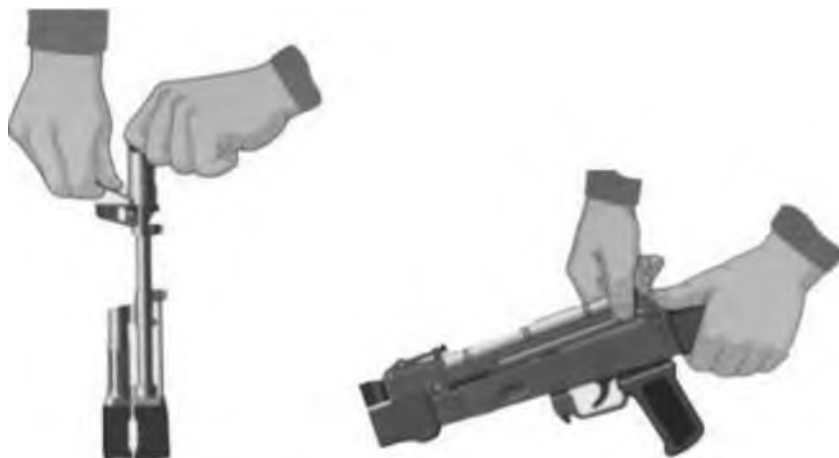
Рис. 7.12. Вынуть пенал с принадлежностью
