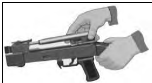
Рис. 7.16. Отделить затворную раму с затвором
