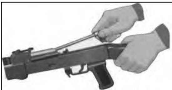
Рис. 7.13. Отделить Рис. 7.14. Отделить крышку шомпол ствольной коробки
