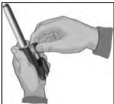
Рис. 7.16. Отделить затворную раму с затвором
