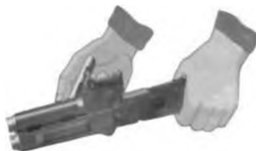
Рис. 7.18. Отделить газовую трубку со ствольной накладкой
