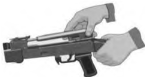
Рис. 7.16. Отделить затворную раму с затвором
