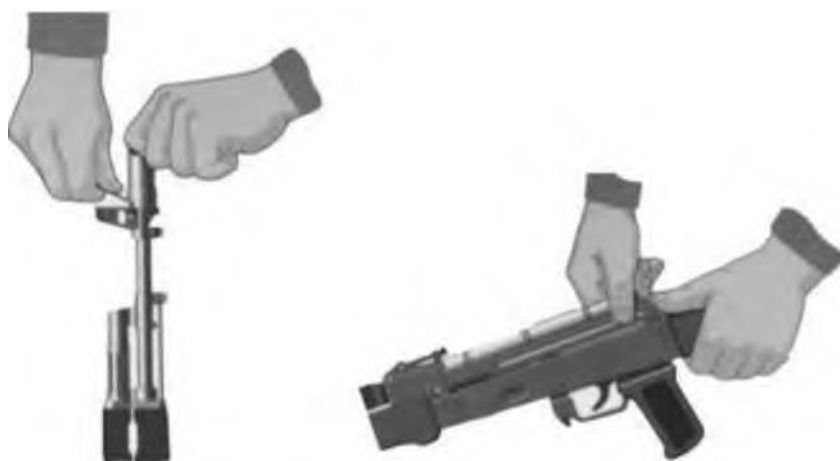
Рис. 7.12. Вынуть пенал с принадлежностью
