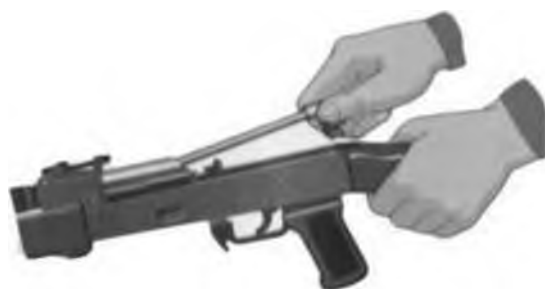
Рис. 7.13. Отделить Рис. 7.14. Отделить крышку шомпол ствольной коробки
